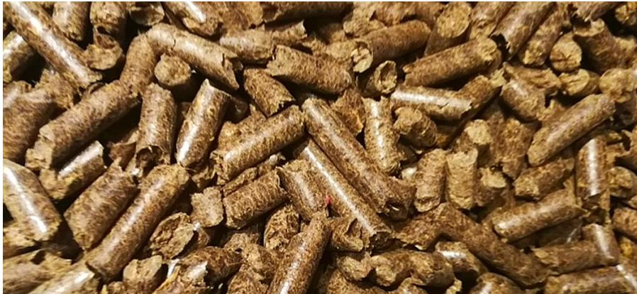
Fot. 12. Pelet z frakcji stałej gnojowicy
