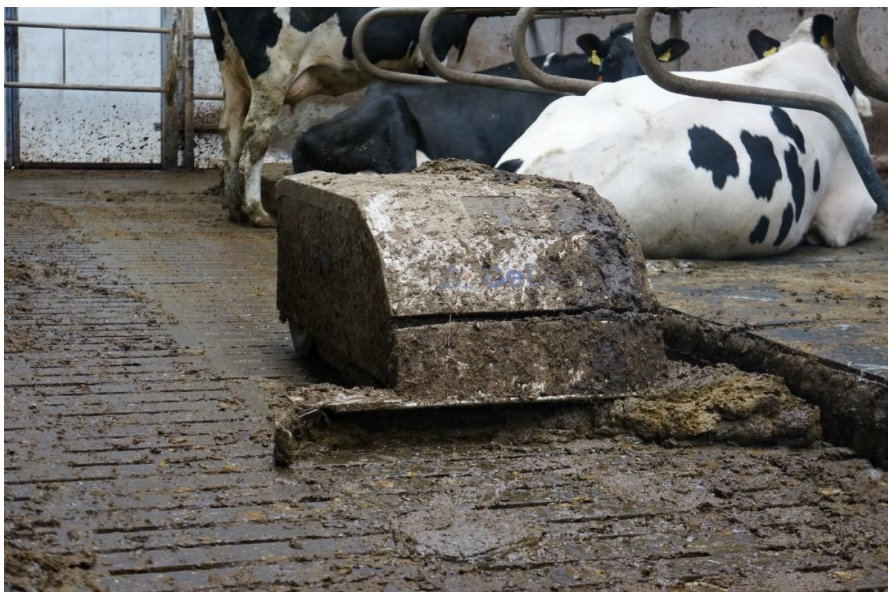
Fot. 2. Robot do czyszczenia podłóg szczelinowych
