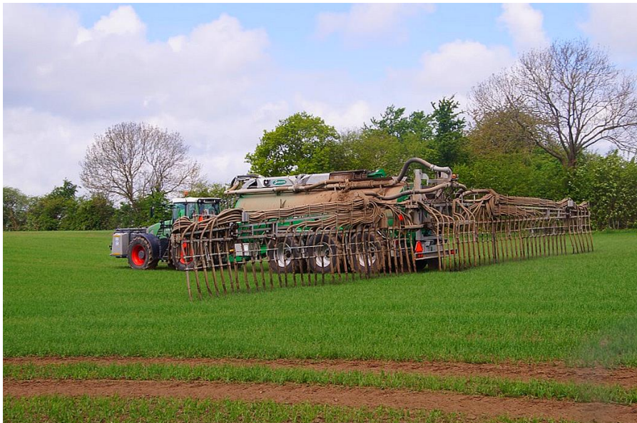
Fot. 13. Zakwaszanie gnojowicy w systemie „in field”
